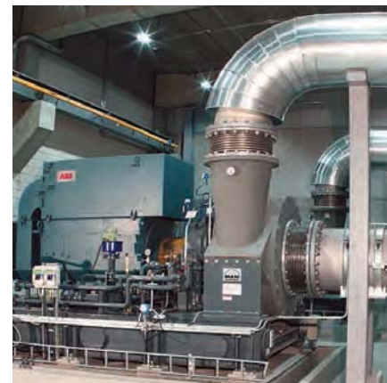
Одноступенчатый вакуумный нагнетатель TURBAIR® для обработки сетчатого сукна
