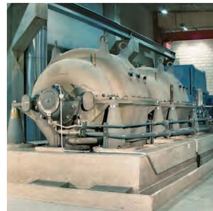
Группа вакуумных нагнетателей TURBAIR® на машине для изготовления газетной бумаги
